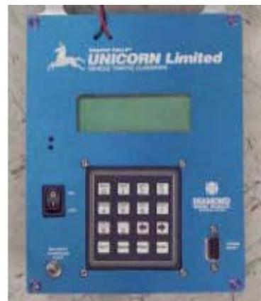
Figura 1: rilevatore Apollo Unicorn limited utilizzato per il monitoraggio
